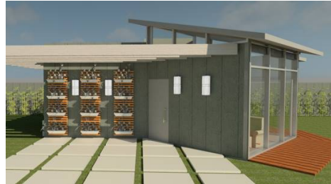
Figura 2: Proposta de Módulo Habitacional Mínimo da equipe de alunos Ellen Andrade, Isabela Tras-si, João Furtado, Juliana Leal e Lívia Lacerda. Utilização de estrutura metálica. Projetos (Elétrico, Hidrossanitário e Estrutural) foram modelados para integração e compatibilização.
