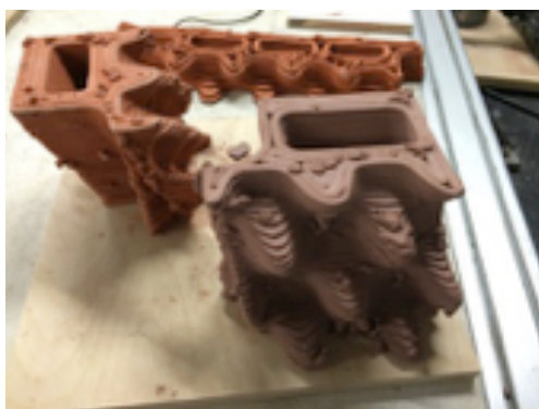
Figura 4: Blocos formados pela extrusão de argila guiada por braços robóticos.
